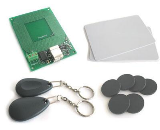
Fig. 3 Types of RFID Tags
