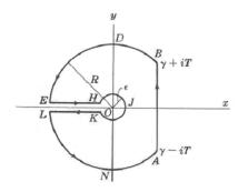
Fig.15. Bromwitch contour C
