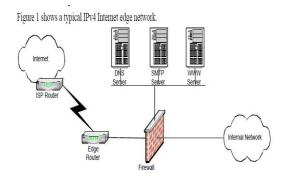
Figure 1 Typical IPv4 Internet Edge Network
